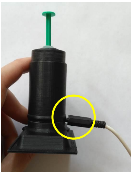
Рис. 5. Место подключения провода заземления.
