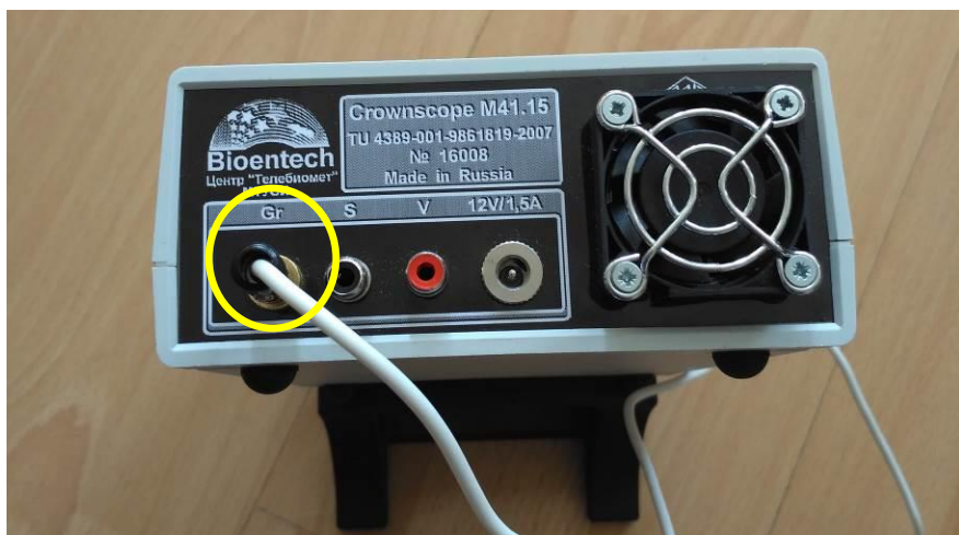
Рис. 2. Место подключения провода заземления.
